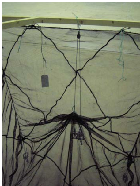
Figur 4-6: Heving av not med skrå tau via loddttau. Den fysiske modellen tilsvarer ei 18 meter dyp fullskala not, mens den numeriske modellen er av ei 12 meter dyp not. Begge modellene har bunntau.
